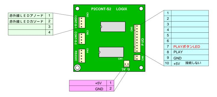
CN1:電源入力 安定化されたDC5Vを入力します(消費電力:100mA以下)
