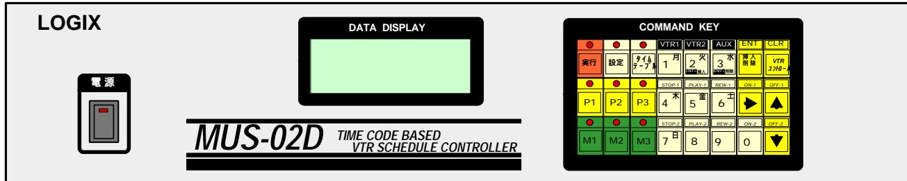
本装置は、タイムコード制御のVTRを2台、AUX1系統の入力をタイムテーブルに従って番組を自動送出する装置です。
