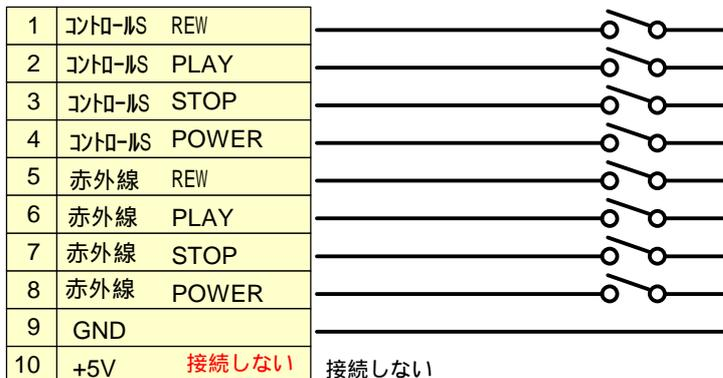
これらの端子をGNDに接続すると、該当するコントロールS、赤外線信号が出力されます。この信号はグラウンドにショートした瞬間のみ、出力されます。同時に複数選択することは禁止です。
