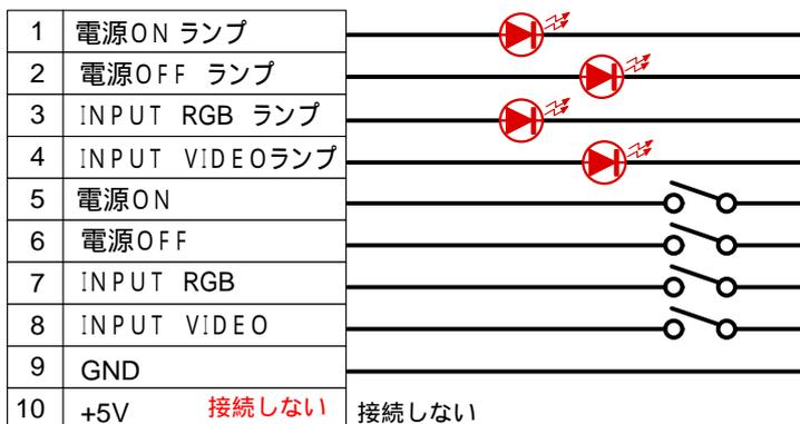
LEDの電流は約15mAになるよう基板上に制限抵抗が入っています。2VタイプのLEDを使用してください。
