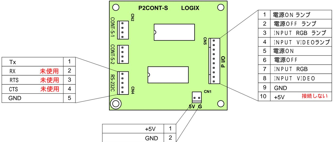
CN1 : 電源入力 安定化されたDC 5Vを入力します(消費電力: 10mA以下)
