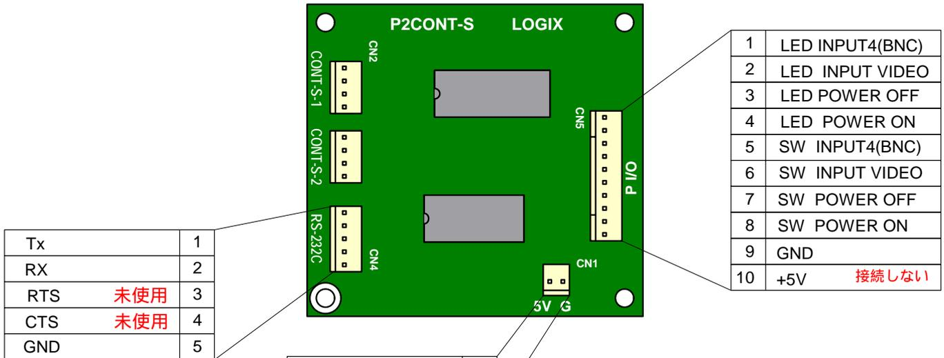
CN1 : 電源入力 安定化されたDC 5Vを入力します (消費電力: DC5V 50mA以下)
