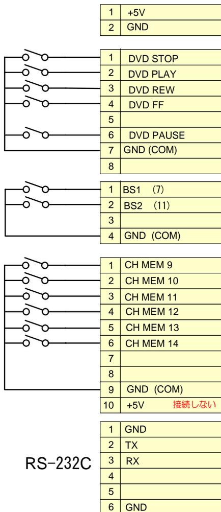
接点入力端子をGNDに接続すると、該当する赤外線信号が出力されます。
