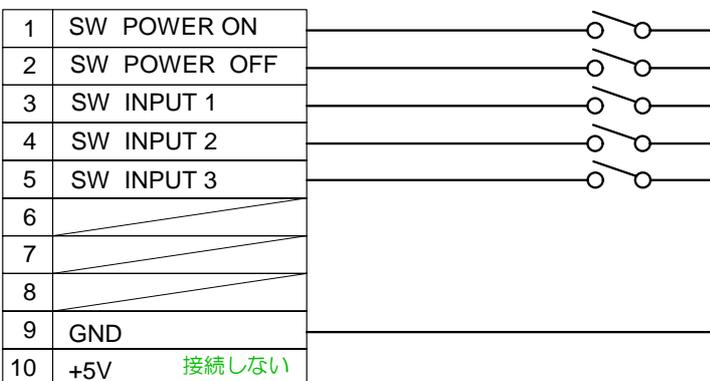
電源OFF時にPOWER-ONスイッチを押すと、プロジェクタの電源が入り、ランプ点灯制御になります。このとき、LED-POWERはオン3、オフ1の割合で点滅します。この期間すべての入力は無効になります。
