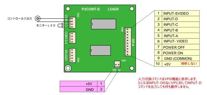
CN1:電源入力 安定化されたDC5Vを入力します(消費電力:50mA以下)
